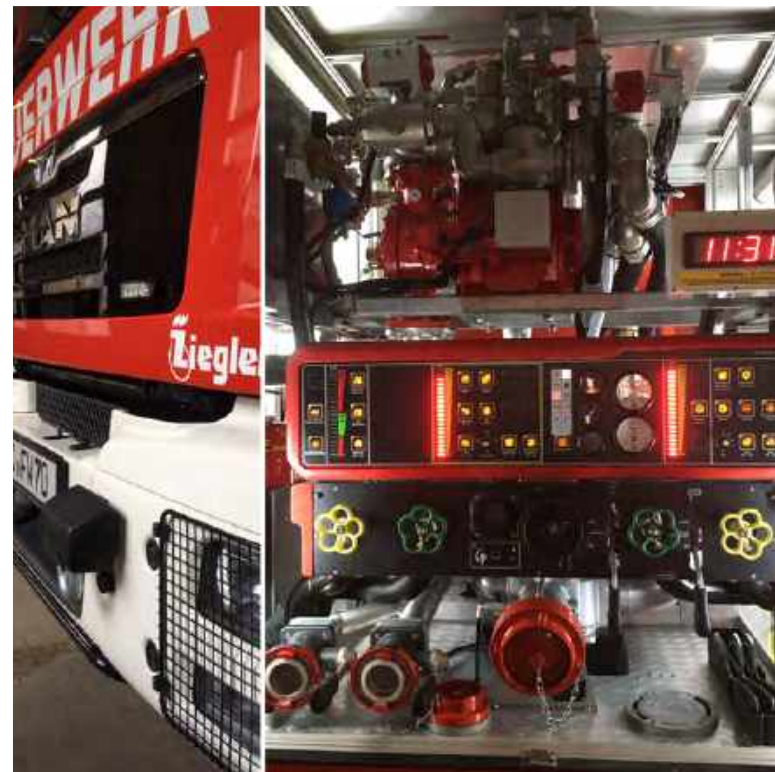
Einblick in den Pumpenraum des TLF 4000
